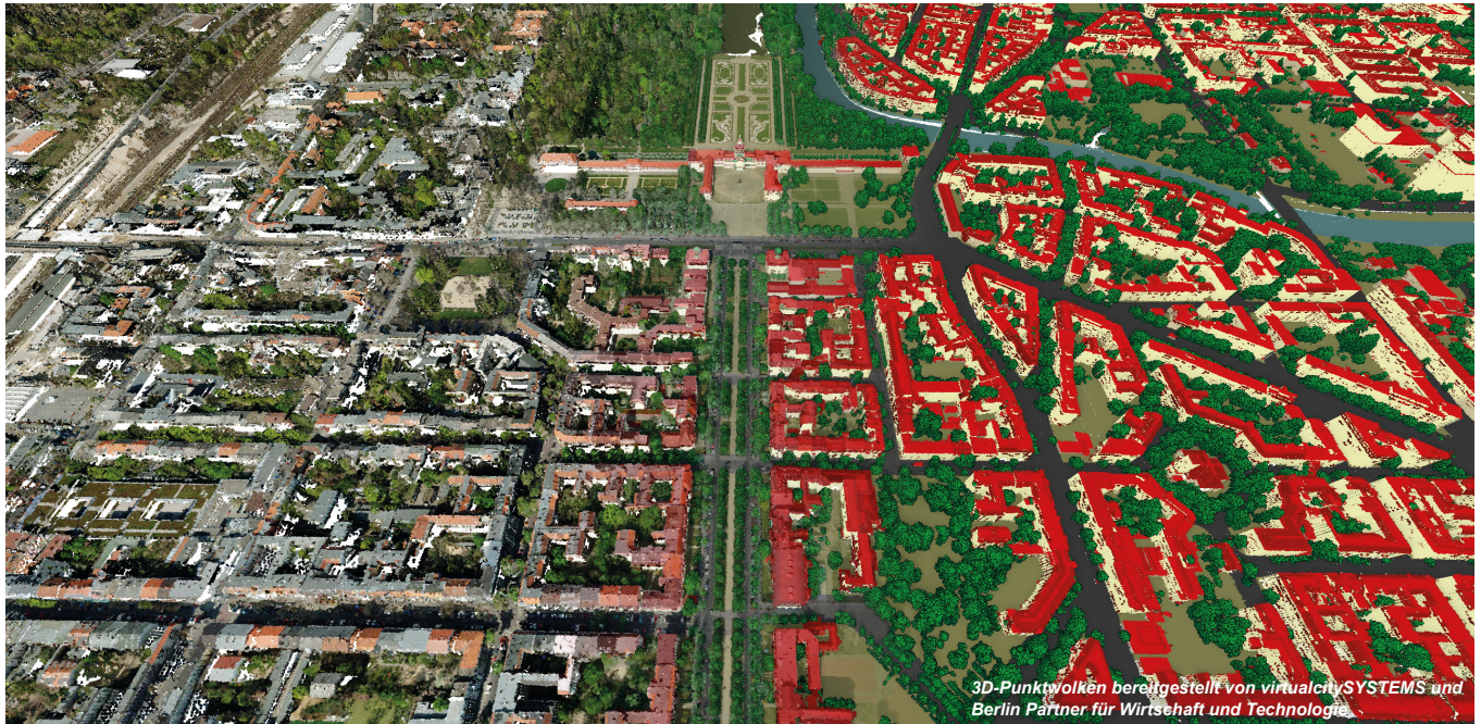
Abb. 1: 3D-Punktwolke einer Befliegung, dargestellt mit Farbinformationen (links) und mit Klassifizierungsergebnissen (rechts)
